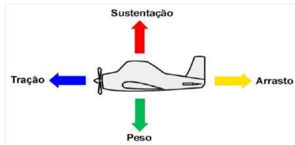
Figura 1 - As quatro principais forças do voo
